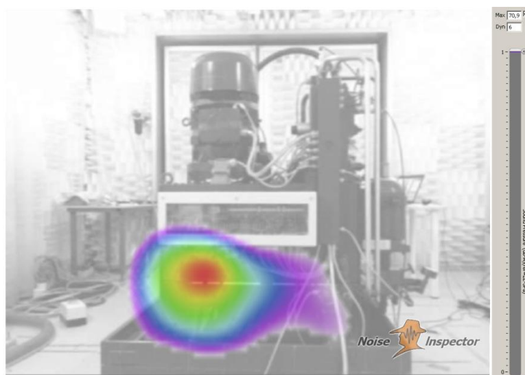
Rys. 7. Zdjęcie wykonane kamerą. Ciśnienie 200 bar – Zakres częstotliwości (1,6-7) kHz Fig. 7. Acoustic Photo. Operating pressure 200 bar. Frequency range (1,6-7) kHz
